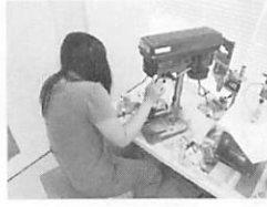
ボール盤で穴開け作業
