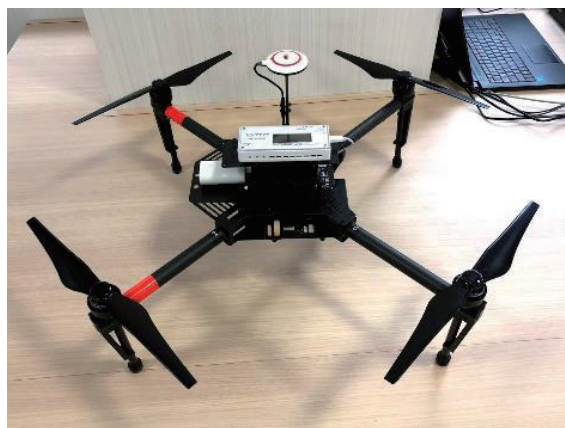
写真4 ドローン (DJI 社 Matrice 100)
