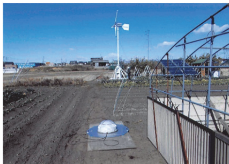
写真 3 風車とフード付マイクロフォン（風向きとほぼ直角方向）
