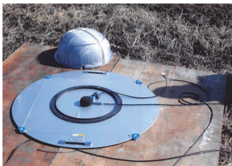
写真 4 フード付マイクロフォンのマイクロフォン位置とそのフードカバー
