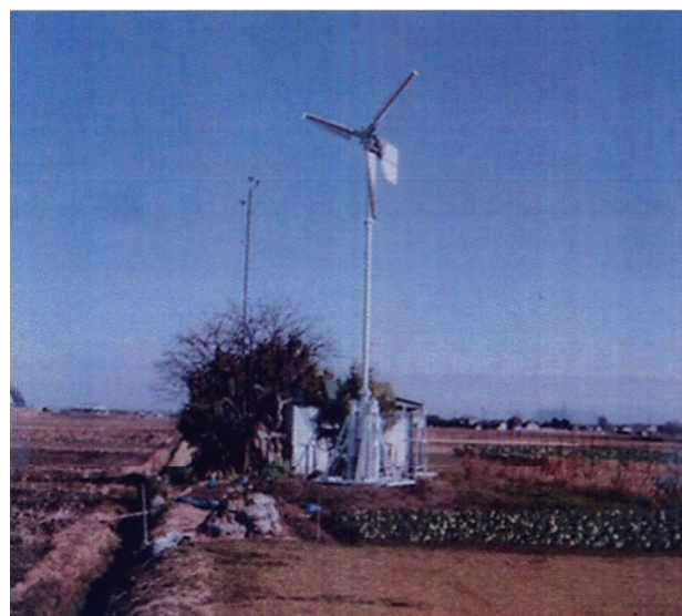
写真2-1 実験用小型水平風車の写真
