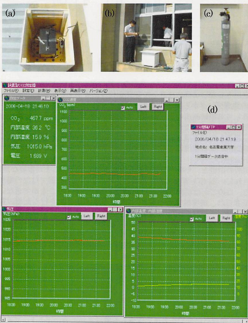
写真 1 CO 2 濃度常時測定システムの概要 ; (a) CO 2 濃度常時測定装置、(b) 百葉箱設置の様子、(c) CO 2 濃度校正用ガス、(d) データ収集用 PC の画面例
