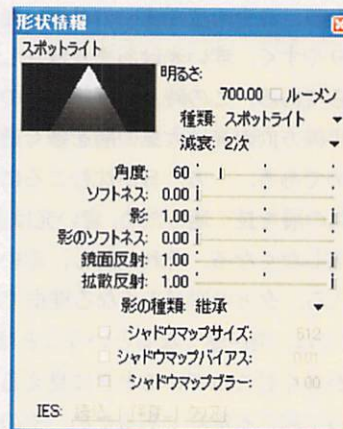
図4：スポット光源の属性設定 (SkyLight2.2)
