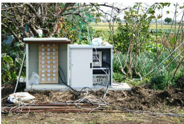
3-13 電球負荷を用いた実景図
