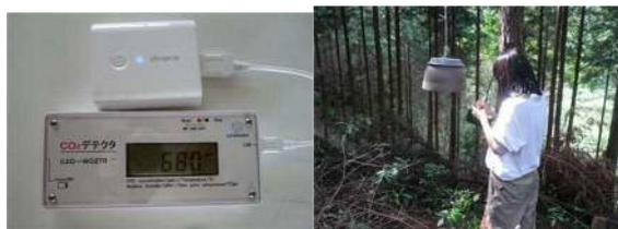
写真1 CO<sub>2</sub>濃度測定器 写真2 定点調査用プロテクター
