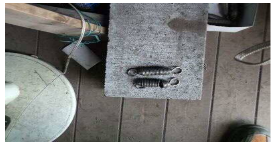
写真6：旧型バネ（上）、改良型バネ（下）
