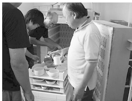
電気窯の窯詰め作業
